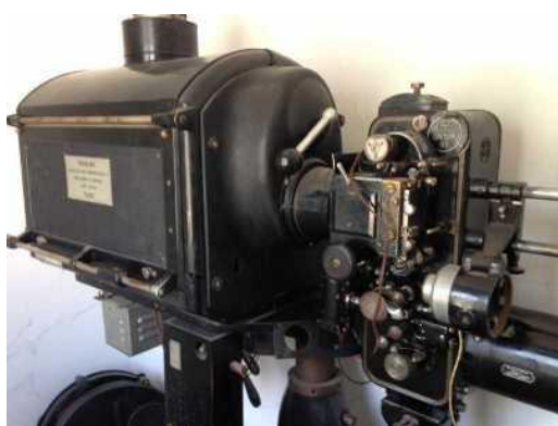
Ez egy Ernemann VII. típusú 35 mm-es hangosfilm vetítógép. Ennek a módosított változatát gyártotta az AUDIO gyár és később a RAFILM.
