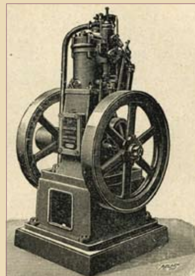
2 ábra Bánki-Csonka állóhengeres stabilmotor (1898)
