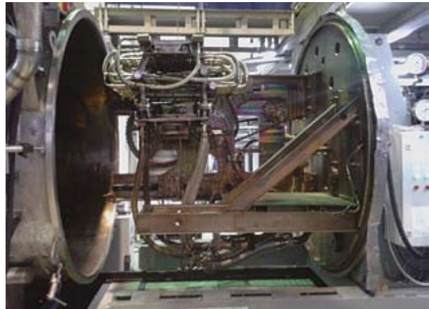
Jefremov Intézet - a divertorok termikus tesztelésére alkalmazott berendezés
