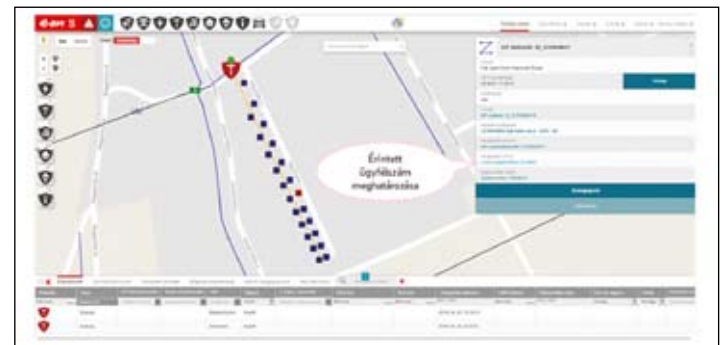
4. ábra Szakaszhiba által érintett ügyfélszám meghatározása
