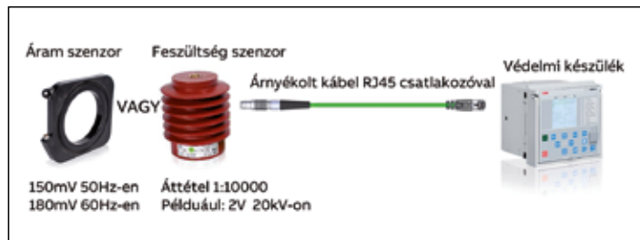
6. ábra A szenzorok csatlakoztatása a védelmi készülékhez
