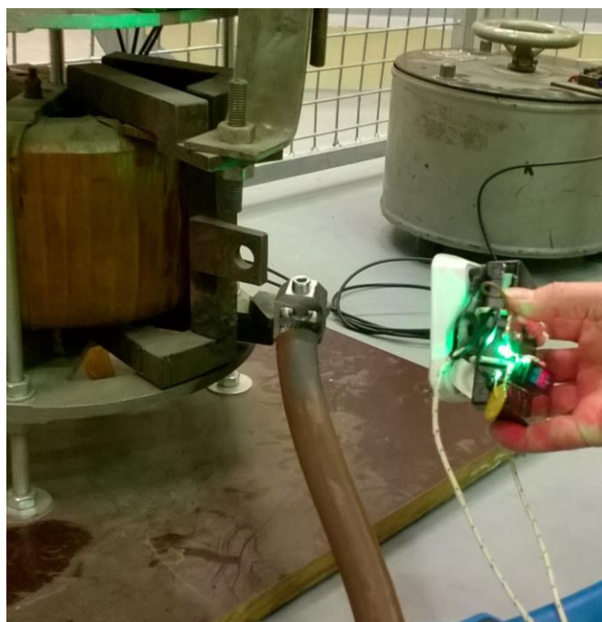
6. Ábra. IP kamera vizsgálata mágneses térben
