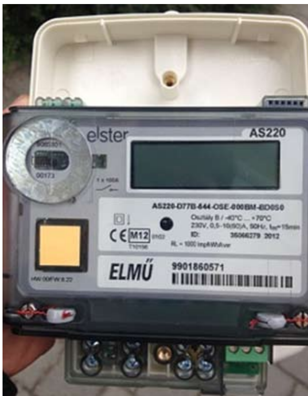
2. ábra Okos mérő üzembe helyezés előtt (kommunikációs modul nélkül)
