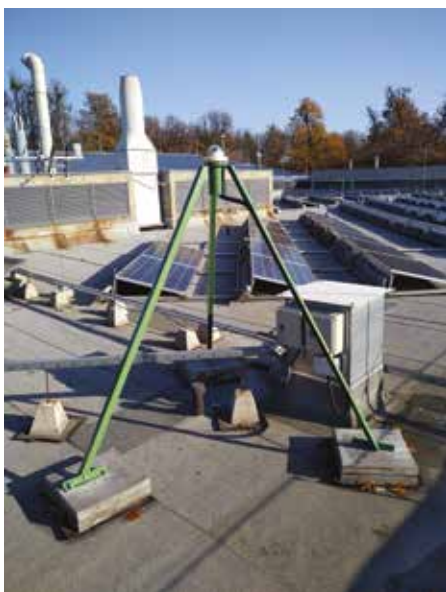
1. ábra Starlight Xpress Oculus típusú égboltkamera az EK telephelyén. Háttérben a napelempark
