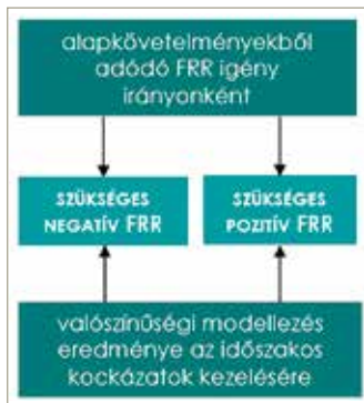
5. ábra Minimálisan szükséges FRR mennyiség meghatározása segítségével
