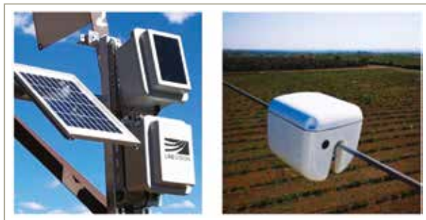
2. ábra Távvezeték felügyeleti szenzorok; a) LiDAR elven működő belógásmérő szenzor; b) kontakt hőmérsékletmérő szenzor [13]
