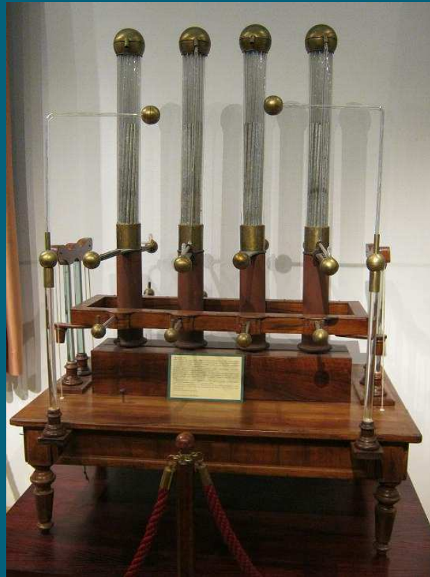
Jedlik Ányos villamfeszítője 1873-ból, az Elektrotechnikai Múzeumban
