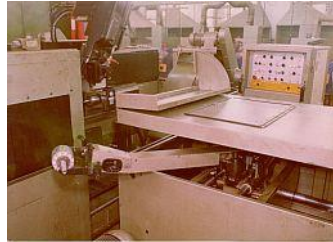
Kalickás forgórész megmunkáló gépsor és kiegyensúlyozás
