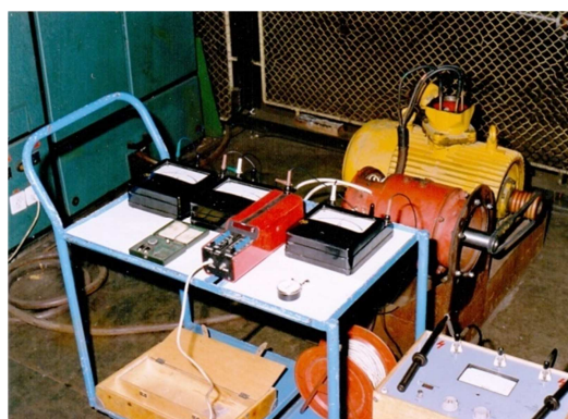
Vizsgálatra váró 3000 V-os 315 kW-os robbanásbiztos villanymotor. Egyenáramú generátor próbája.
