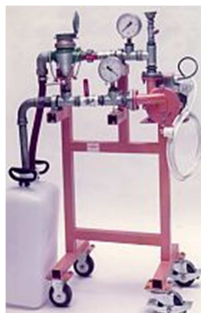
Vízszivattyú vizsgáló. Fáziskimaradás ellen védő főkapcsoló Csibe telepekhez.
