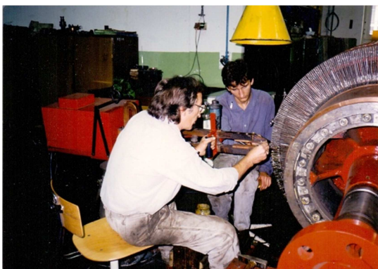
Ward-Leonard vezérgenerátor kommutátor zászlóinak forrasztása.
