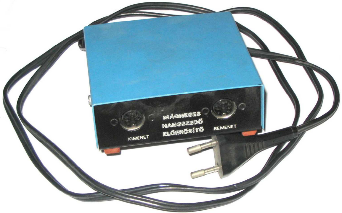
GE 80-9 tip. Mágneses hangszedő előerősítő
