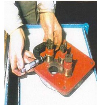
Csapágy lehúzás, körmös lehúzóval. RB. motor HO pajzsának ellenőrzése. Átvezető szigetelő méretellenőrzése.
