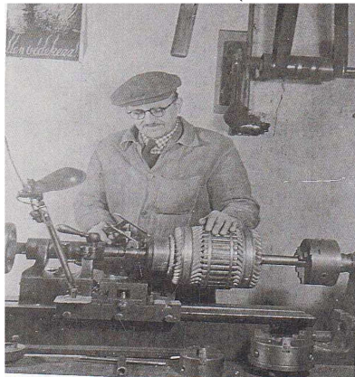
Fazekas Ferenc egy kommutátor szabályozása közben.
