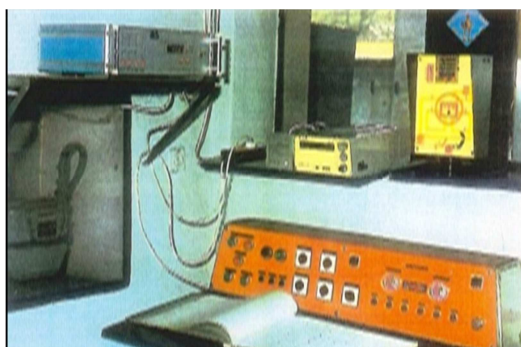
Robbantókamra vezérlőpultja dinamikus nyomáspróba elvégzéséhez
