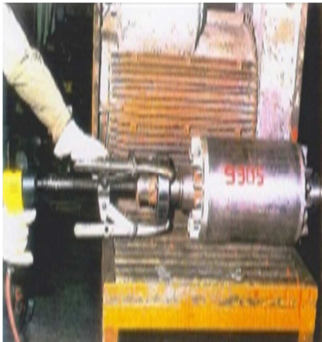
Csapágy lehúzás, körmös lehúzóval. RB. motor HO pajzsának ellenőrzése. Átvezető szigetelő méretellenőrzése.
