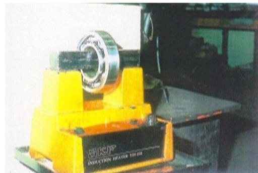
Csapágy melegítése indukciós melegítővel
