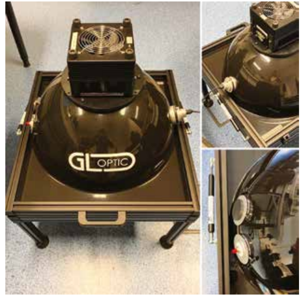
10. ábra A GL Optic által az AI-TWILIGHT projekt számára kifejlesztett optikai teszthardver kívülről
